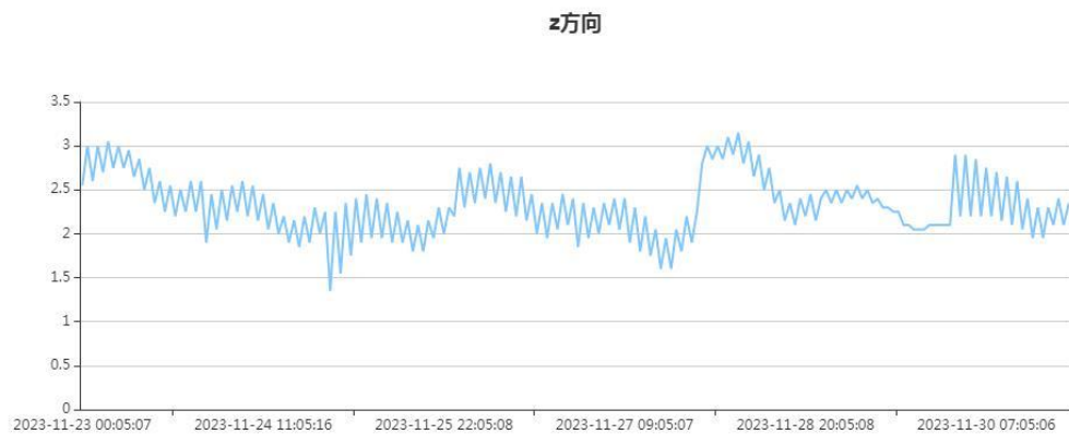
图10 G3竖向位移累计变化曲线 ( mm )
