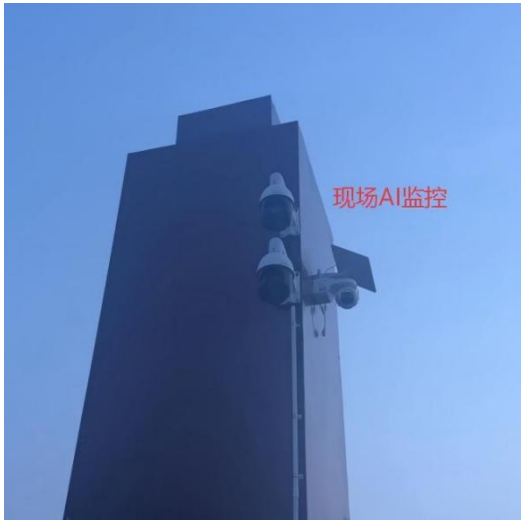
图3 立柱高位双机位 AI 球机实拍
