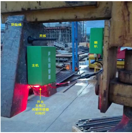
图10 AI十不吊方案现场布置示意图
