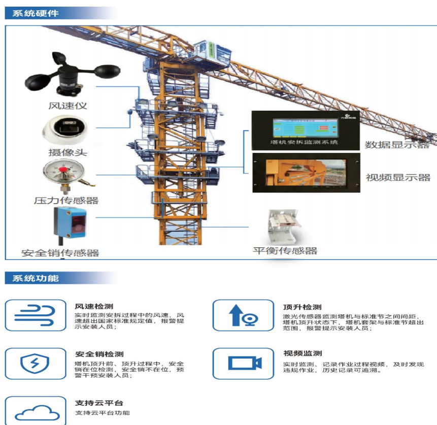
图2 安拆预警系统示意图
