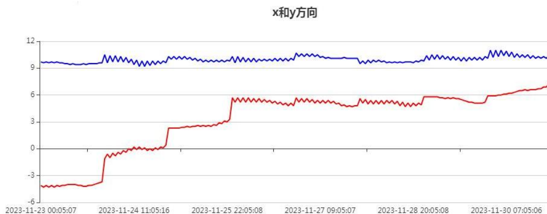
图9 G3水平位移累计变化曲线（mm），红色表示X方向，蓝色表示Y方向
