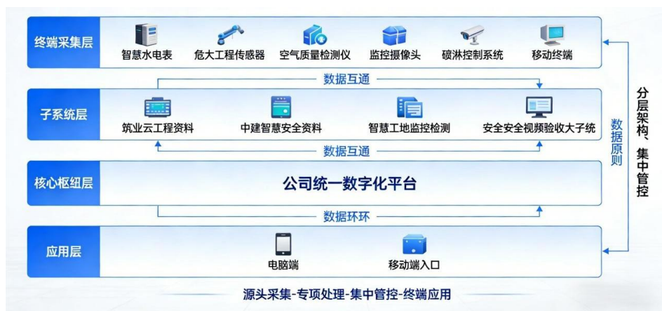
图 5 项目数字化管理系统整体拓扑示意图
