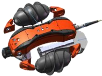
图7 满水/高水位管道工况检测机器人
