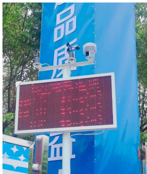
图16-1 现场扬尘监测装置
