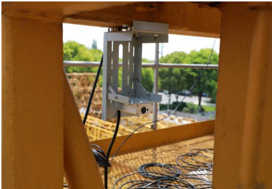
图5 塔吊平衡检测
