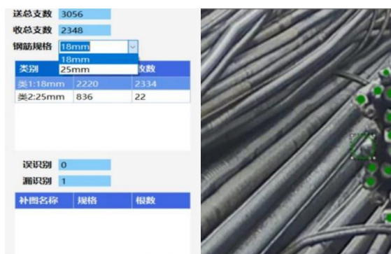
图8 选择不同直径钢筋计数图
