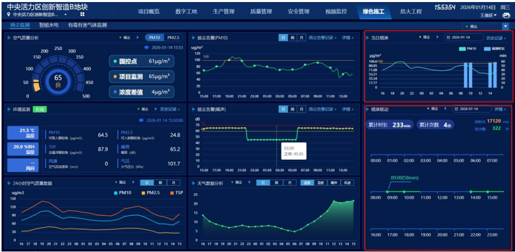
图3 喷淋联动自动作业
