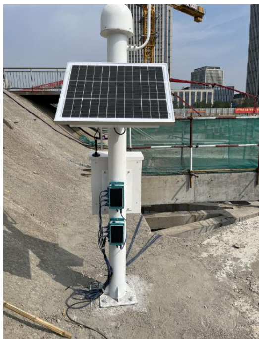
图5 基于GNSS自动化监测系统水平和竖向位移观测点布置图
