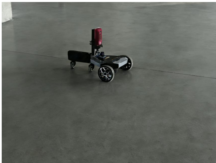
图4 地坪机器人现场实测图
