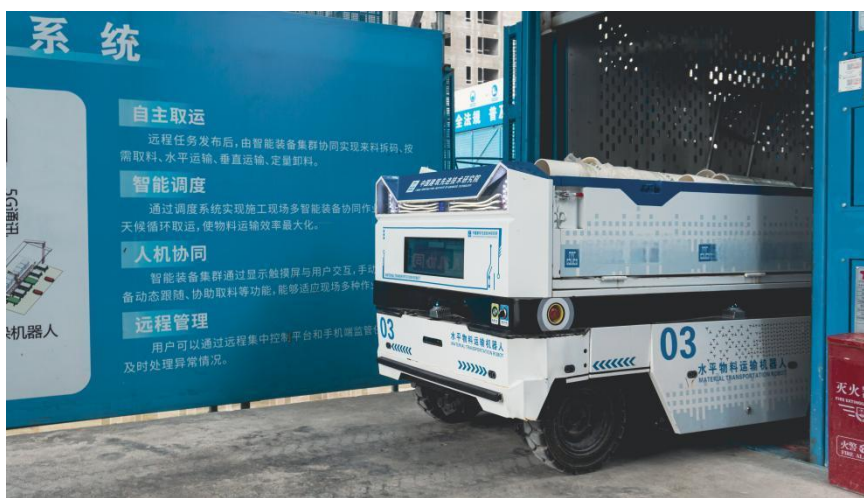
图8 机器人自主进电梯照片
