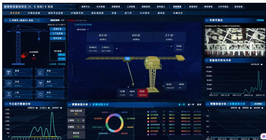
图7 智慧工地平台塔吊群实时监测界面，显示各塔吊运行参数与防碰撞模拟状态
