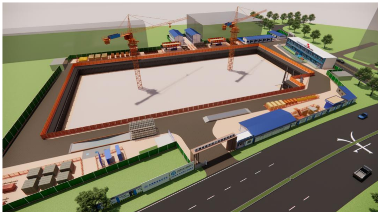
图6 施工基础阶段BIM场平布置
