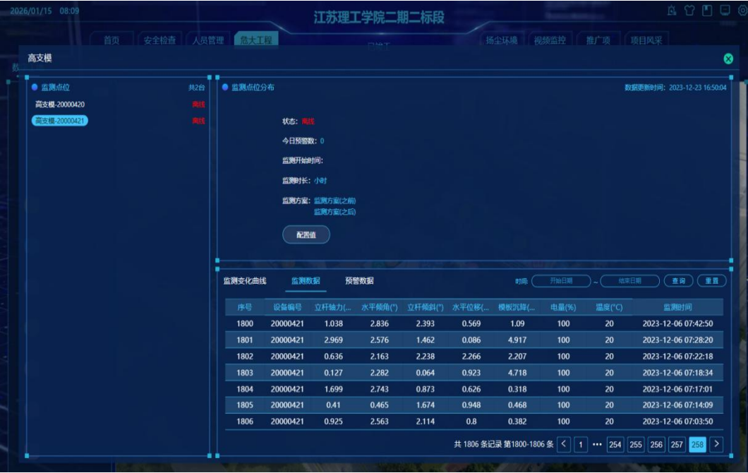
图5 智慧工地平台高支模监测数据图
