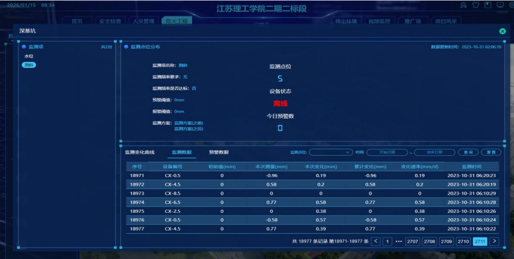
图10 智慧工地平台深基坑测斜监测数据图
