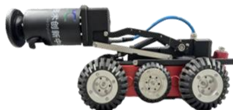
图8 无水/低水位管道工况检测机器人
