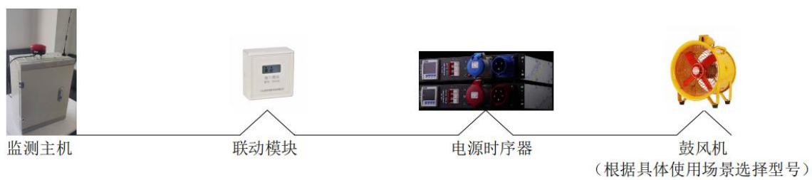
图 4 有毒有害气体通风系统简易拓扑图
