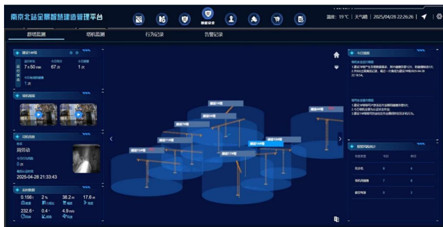
图7 塔吊防碰撞系统
