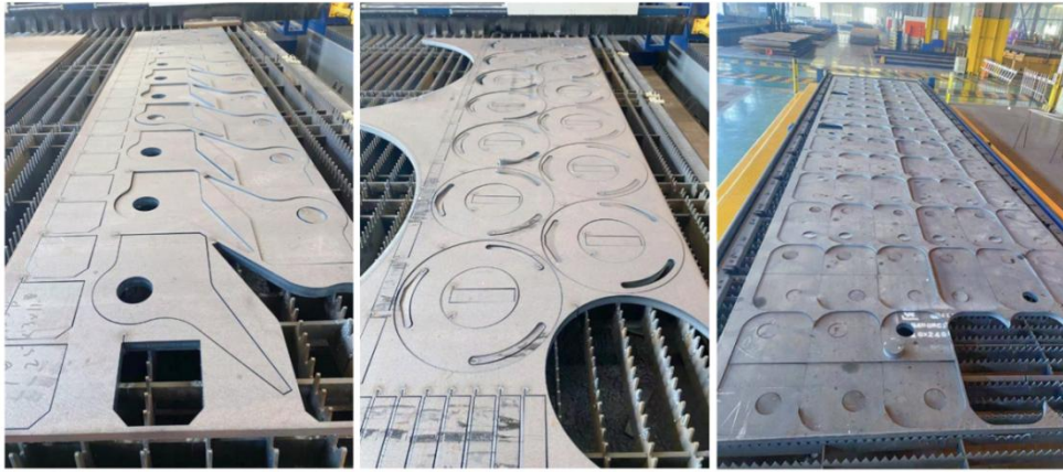
图7 高精度激光切割场景实拍
