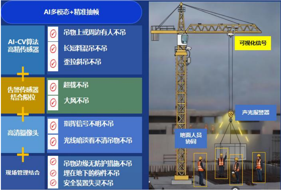
图8 塔机十不吊AI监控场景及对应解决方案
