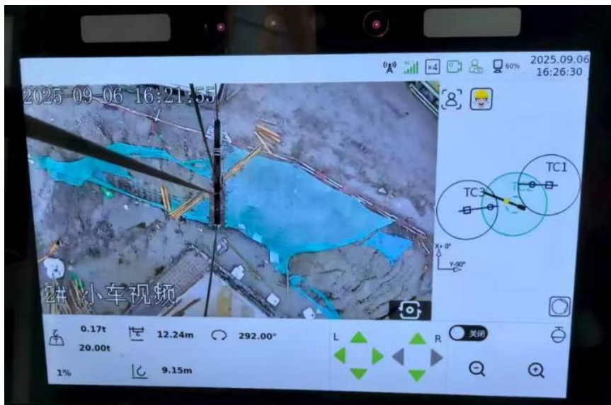
图2 塔式起重机安全监控系统
