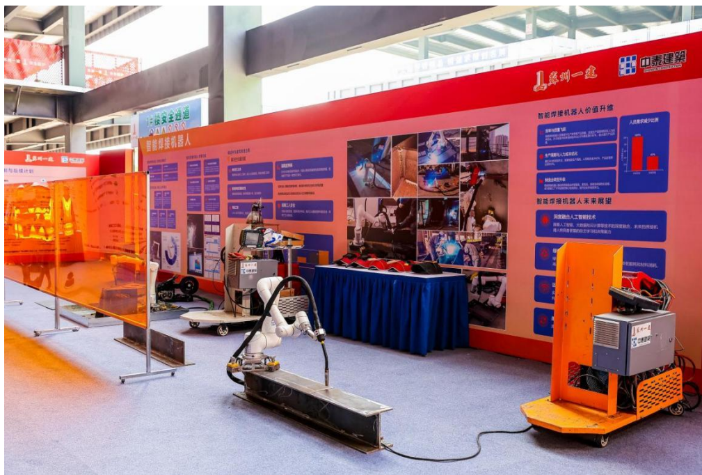
图10 焊接协作机器人调试场景
