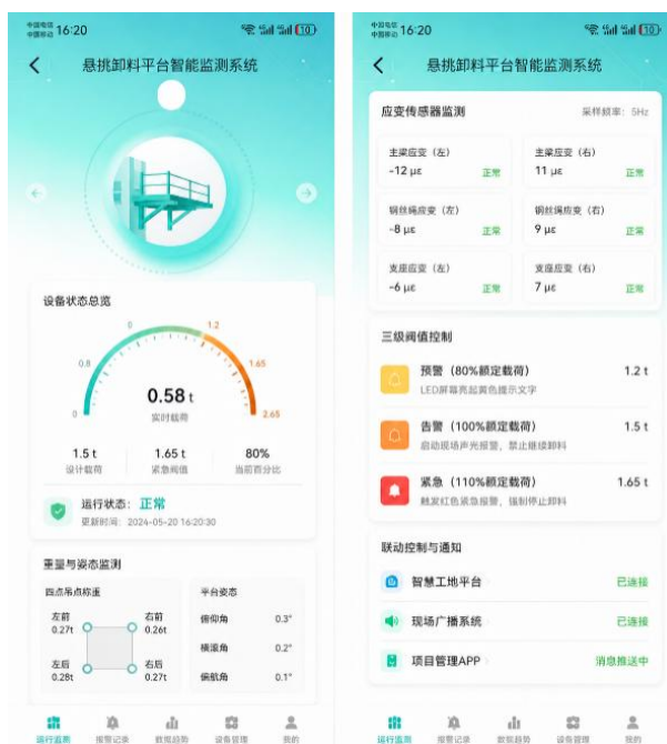
图10 软件平台APP界面图：卸料平台实时荷载监测与预警控制
