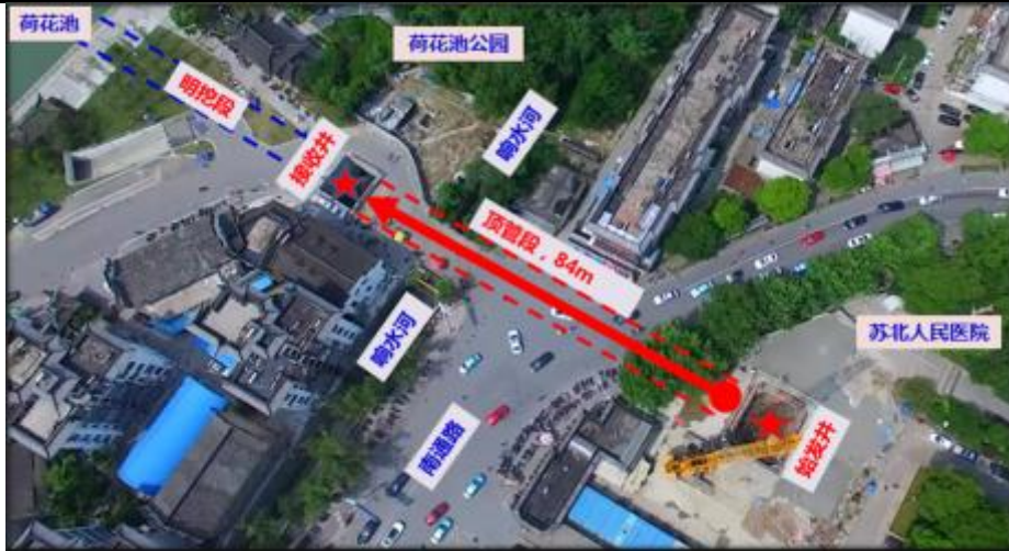
地下顶管通道施工示意图
