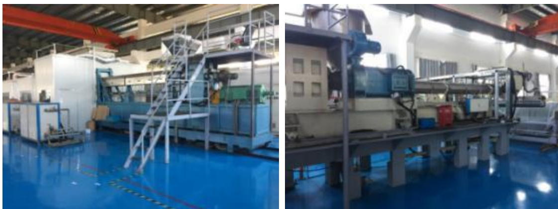
图1. EVA胶膜挤出流延生产线
