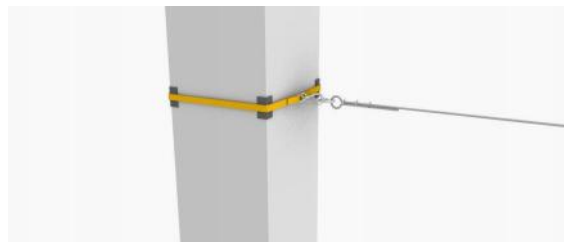
使用扁平吊装带设置生命线效果图
