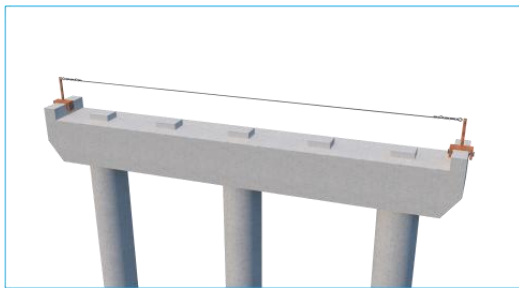
盖梁垫石作业水平生命线效果图
