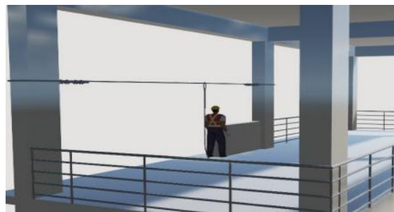
使用扁平吊装带设置生命线效果图
