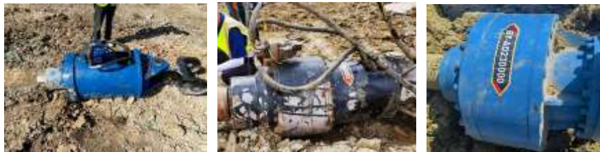
图 8 BY-AD100000、160000、230000 型号液压力头
