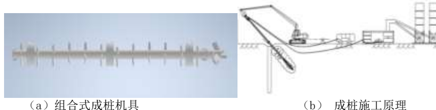
图 10 三重管高压旋喷与单轴搅拌法组合式成桩机具及施工原理
