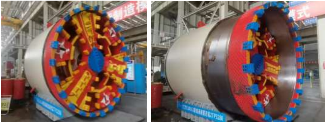
环形切削刀的缩回及伸出状态
