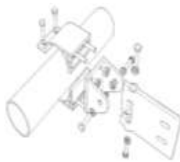
图 34 曲面幕墙安装固定结构
