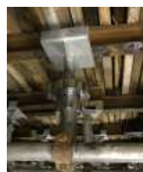
图 27 轴压传感器布置
