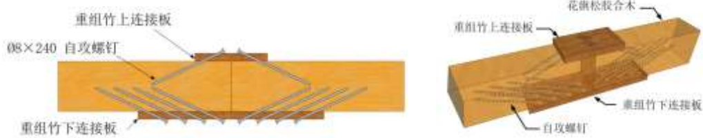
图 3 重组竹-自攻螺钉拼接梁技术
